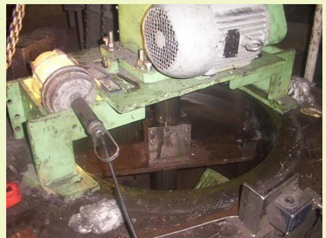
Mandrilhamento de mancais Até 1 metro de diâmetro.
